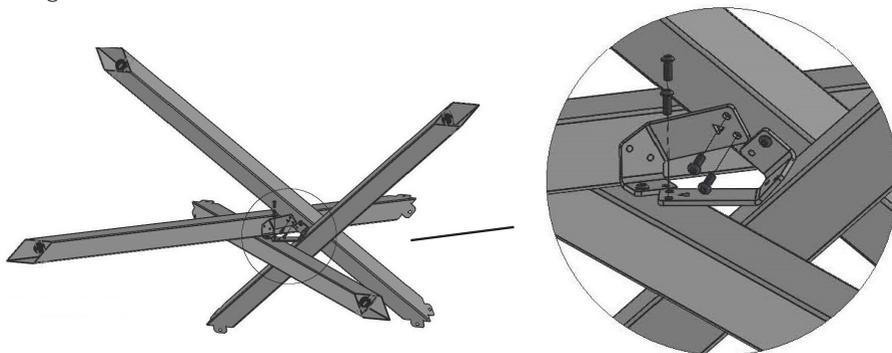
Accoppiare un tubo per tipo, avvitare e montare i piedini (Fig.1)
